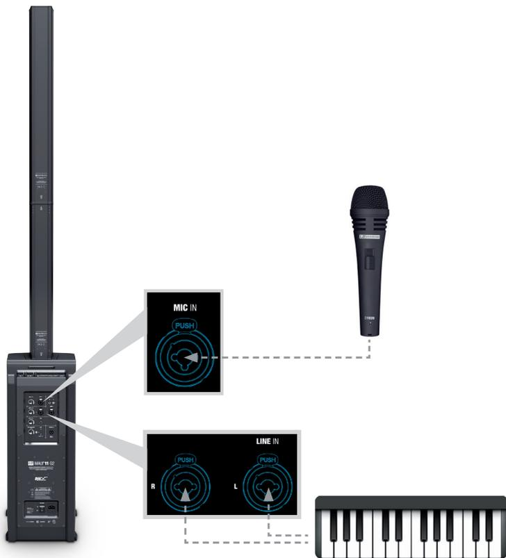
Exemple pour le mode de fonctionnement Stereo
